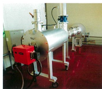
高温熱風発生炉 (800～1000℃)
